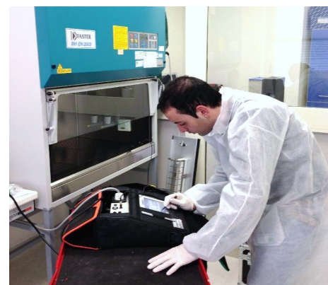
Test d'integrità dei filtri HEPA in S.O. e prove di sicurezza elettrica su cappa a flusso laminare
